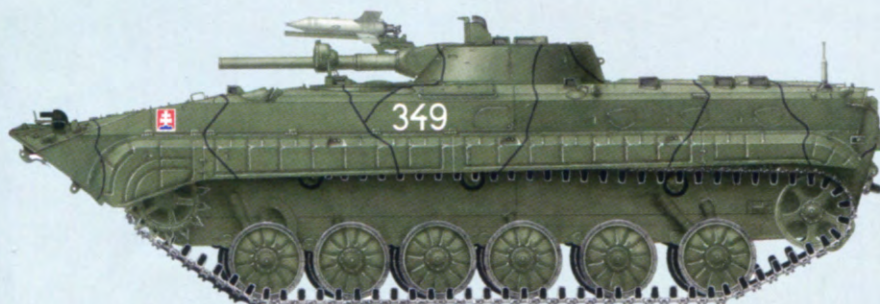
ВВР-1, лицензионный вариант советской БМП-1, одного из подразделений современной словацкой армии. 2007 год. Тонкие черные полосы – разметка для быстрого нанесения пятен камуфляжа в зависимости от местности и времени года.
